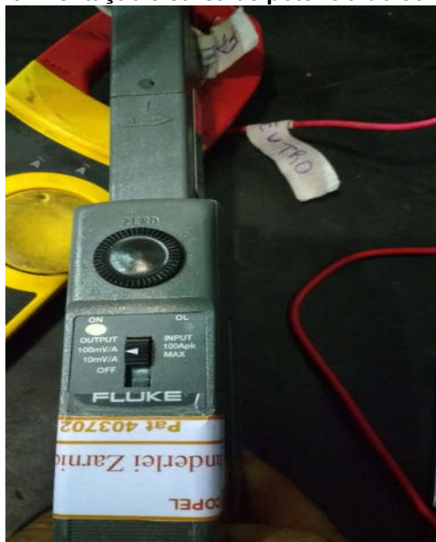
Fotografia 13 - Pinça de corrente de precisão conectada a alimentação elétrica de potência do controle eletrônico.
