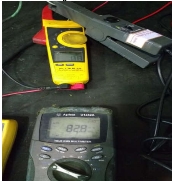
Fotografia 12 - Medição de grandeza elétrica em ampères do controle eletrônico do religador.
