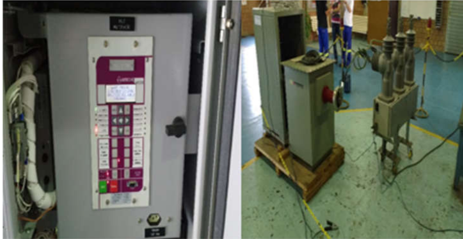
Fotografia 10 - Controle eletrônico e religador automático Arteche.
