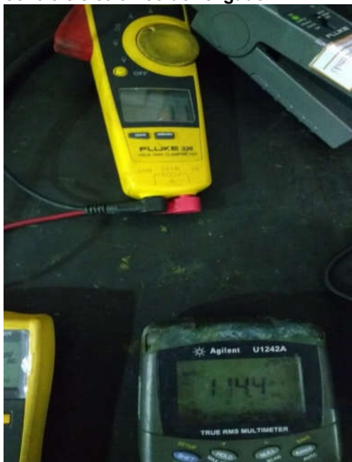
Fotografia 14 - Medição de grandeza elétrica em ampéres do controle eletrônico do religador.
