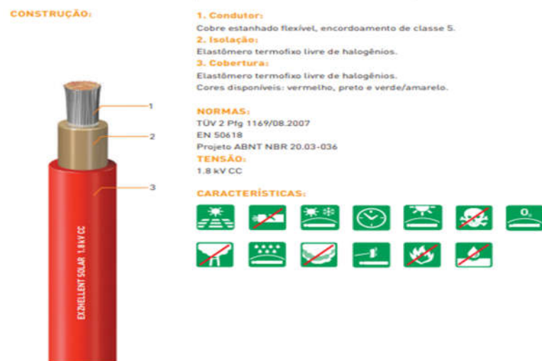
Figura 18 - Cabo para Aplicação em Sistemas Fotovoltaicos.
