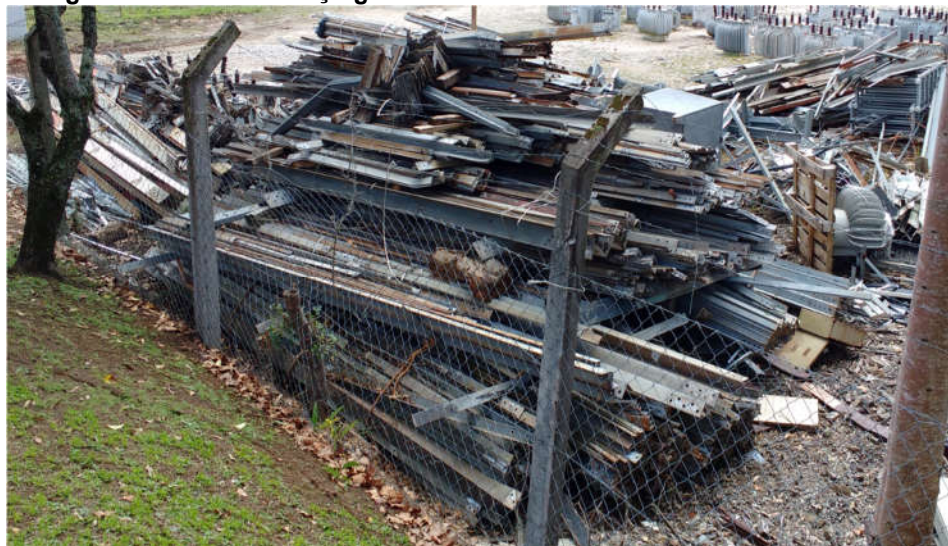
Fotografia 19 - Perfis de aço galvanizados salvados de obras.
