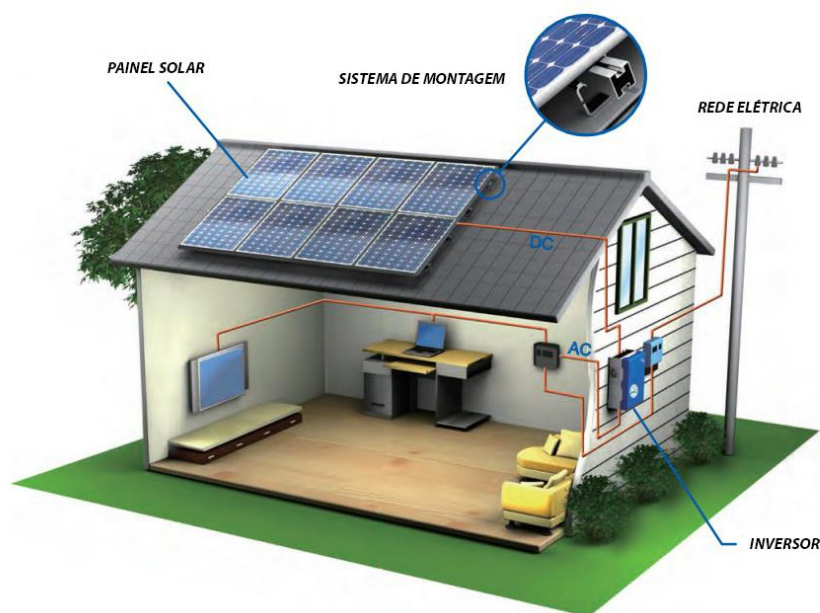
Figura 27 - Sistema Conectado à rede
