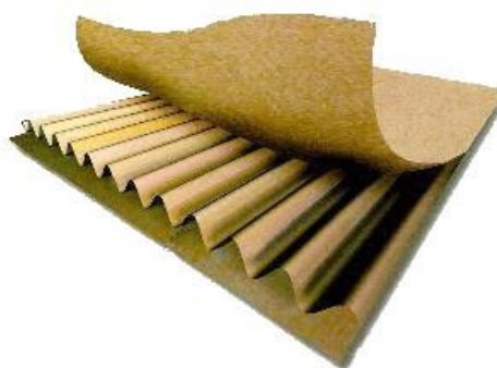
Figura 6 - Camadas do papelão ondulado
