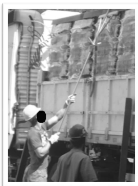
Figura 6 - Uso da ferramenta para retirada das cantoneiras
