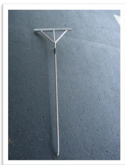
Figura 7 - Ferramenta para retirada de cantoneira Fonte: O autor, 2018.
