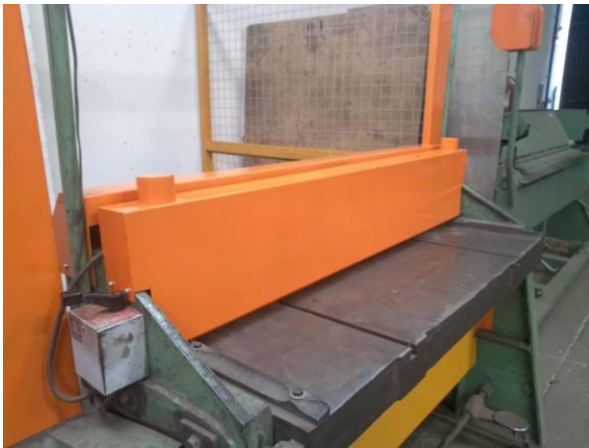
Figura 9: Área dos Mordentes após adaptação
