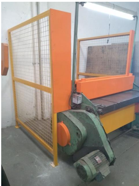
Figura 11: Área da Polia e Correias após adaptação
