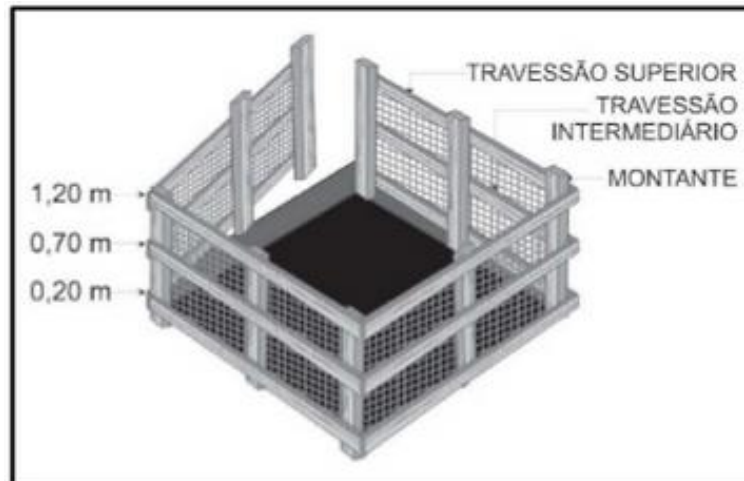
Figura 4 - Fechamento de abertura de laje. Fonte: Guia para elaborar análise risco (2012).
