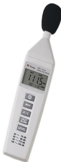
Figura 5. Decibêlmetro Digital Portátil Faixas de medida 40dB ~ 130dB Resolução: Minipa MSL-1325 a Fonte: Dados do pesquisador.
