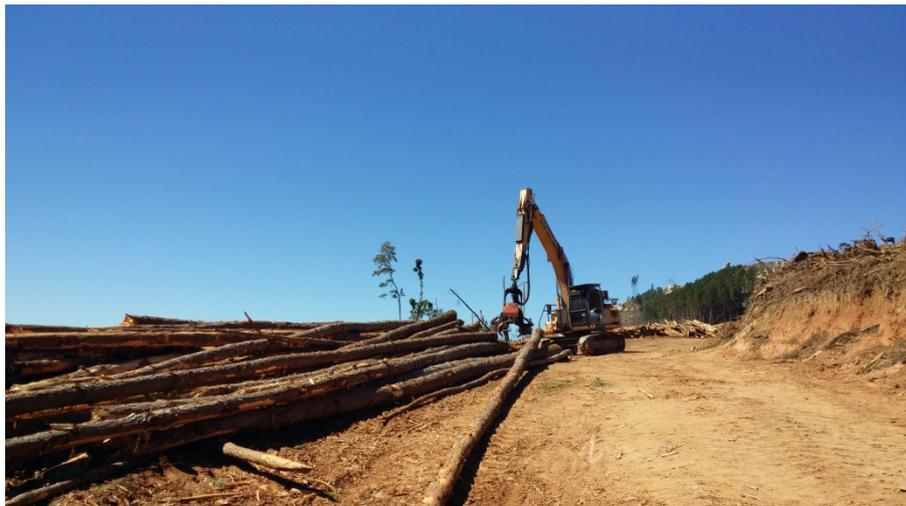
**Figura 7. Processador florestal realizando sectionamento das toras na beira do ramal.
