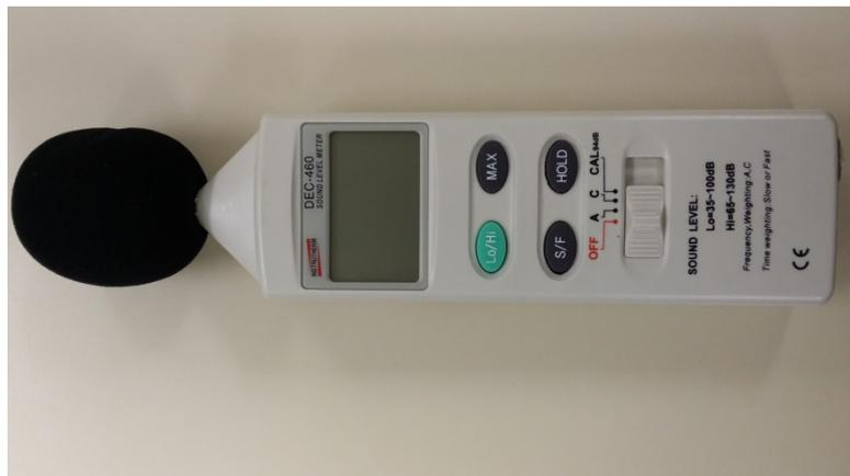
Figura 2. Decibelímetro *Instrutherm* DEC-460, para medições de ruído.
