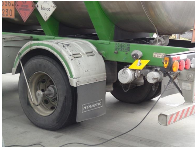
Figura 7 – Caminhão aterrado antes de qualquer operação.
