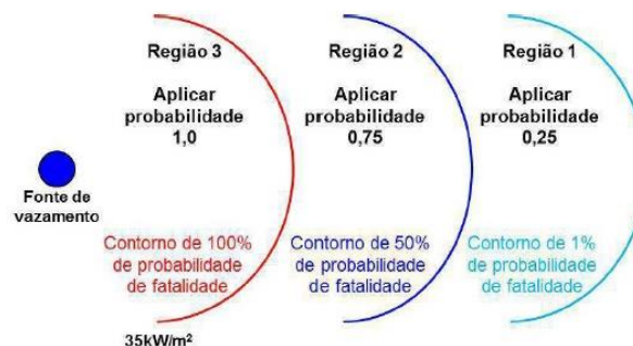
Figura 29 - Representação das regiões de probabilidade de fatalidade para os efeitos de radiação térmica. Fonte: CETESB (2011).
