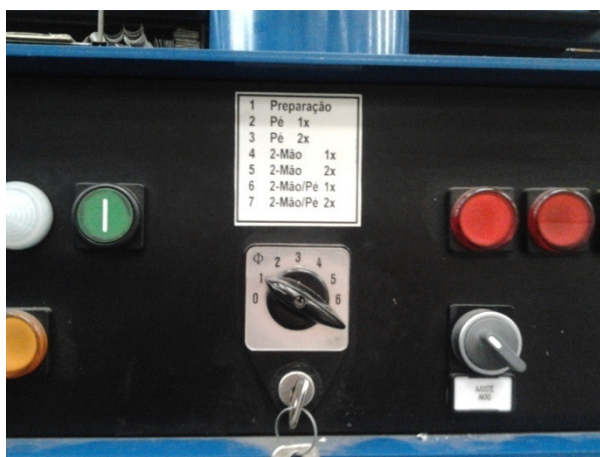
Figura 18. Painel de comando chave seletora com identificação de função Fonte: o autor
