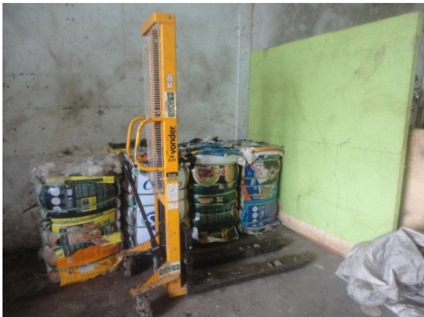
Figura 4 – Empilhadeira manual utilizada para transporte de tambores e bags.
