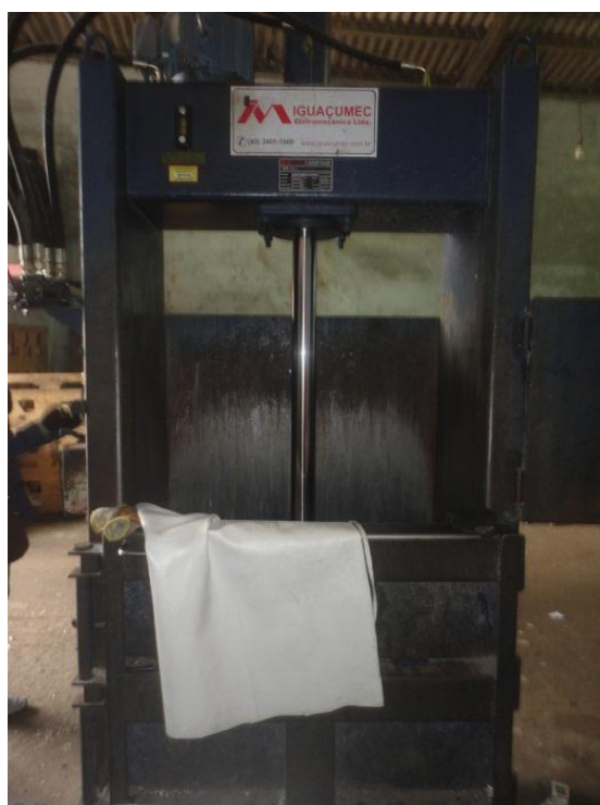
Figura 3 - Prensa hidráulica utilizada para produção de fardos de plástico e papel. Fonte: A autora (2013).
