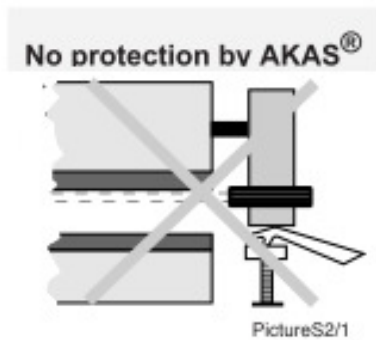
FIGURA 7. AVISO DE PERIGO GERADO PELO DESLOCAMENTO DO SENSOR. FONTE: FABRICANTE FIESSLER.
