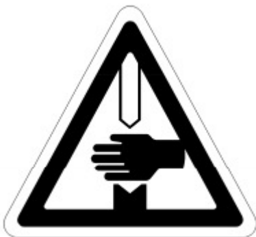
FIGURA 6. AVISO DE PERIGO DE ESMAGAMENTO. FONTE: ABIMAQ.
