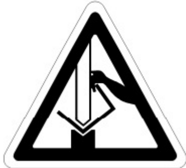
FIGURA 4. AVISO DE PERIGO DE Prensagem da mão entre peça e avental superior durante a dobra. FONTE: ABIMAQ.
