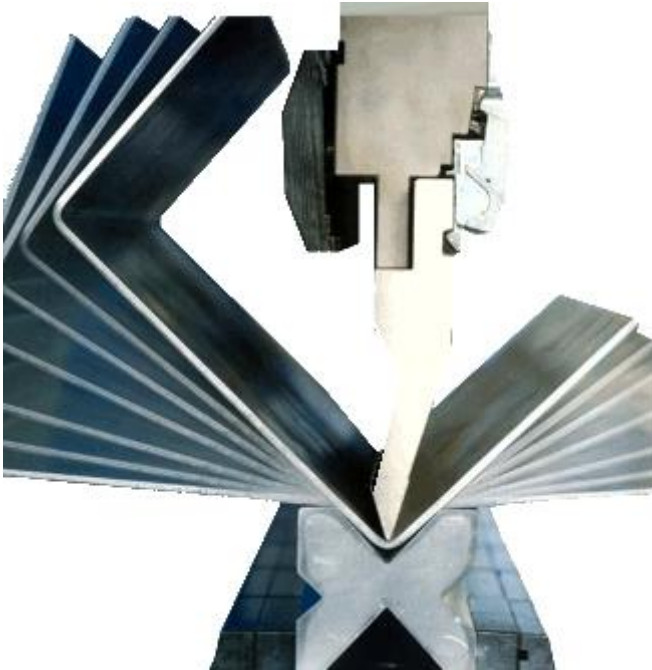
FIGURA 2. FERRAMENTAS E ÂNGULOS DE DOBRAS DE CHAPA. FONTE: WWW.CHINAFERTILIZERUNIT.COM.
