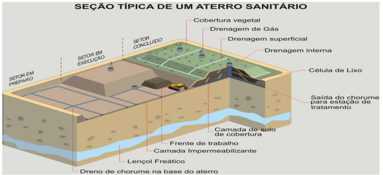
FIGURA 1 - ESQUEMA OPERACIONAL DE UM ATERRO SANITÁRIO FONTE: MANUAL DE OPERAÇÃO DE ATERROS SANITÁRIOS. GOVERNO DO ESTADO DA BAHIA (2012)
