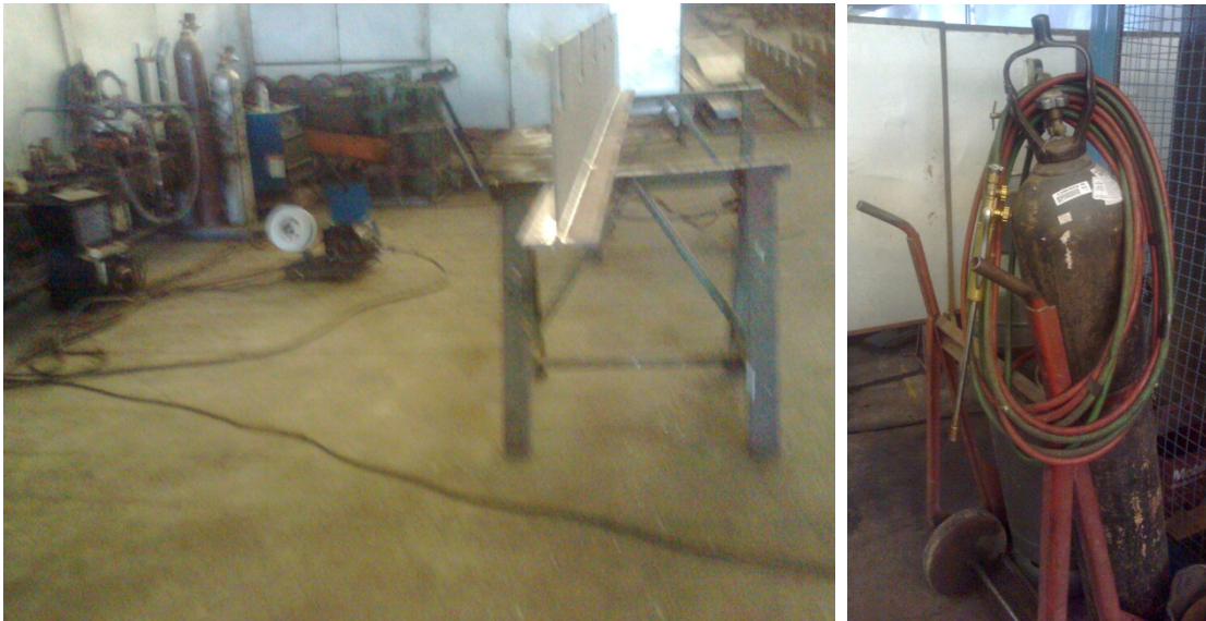
Figura 8 – Local de soldagem MIG/MAG com máquina de solda e conjunto para oxicorte.
