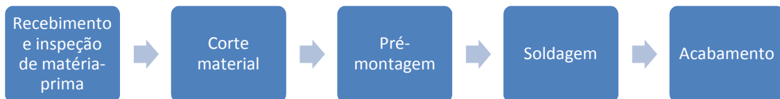
Figura 4 - Fluxograma do processo de produção.
