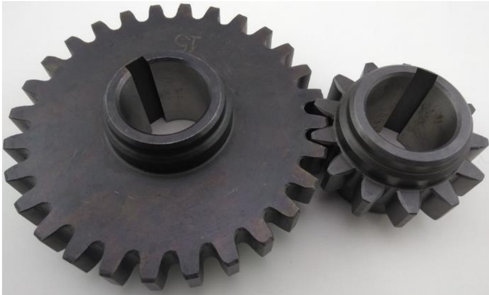
Figura 17 - Foto de um dos pares de engrenagem sem revestimento.
