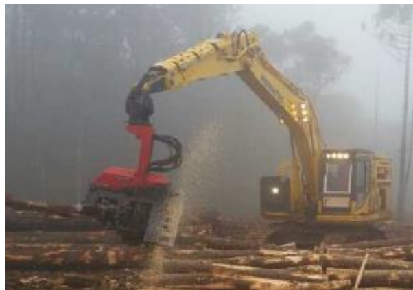
Figura 4: Harvester de esteira montado na escavadeira com cabeçote processador Fonte: Augustin (2015).
