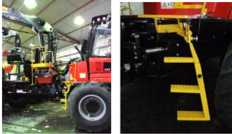
Figura 19: Escada extra para acesso aos tanques de diesel e hidráulico, pega mão e patamar de acesso aos tanques Fonte: O autor (2017).
