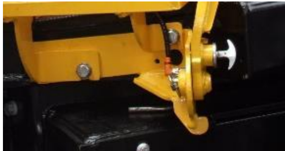
Figura 20: Alteração no pegador do pino minimizando o risco de acidentes por esmagamento Fonte: O autor (2017).
