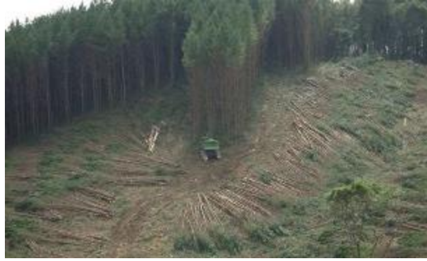
Figura 3: Árvores derrubadas no campo sob o sistema de toras compridas Fonte: Komatsu Forest (2015).
