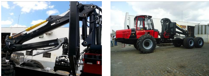
Figura 22: CLAMBUNK (895) sem sinalização
