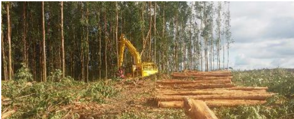
Figura 2: Sistema de toras curtas
