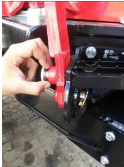
Figura 17: Trava da escada tipo “trava pino” proporcionava risco de acidente Fonte: O autor (2017).
