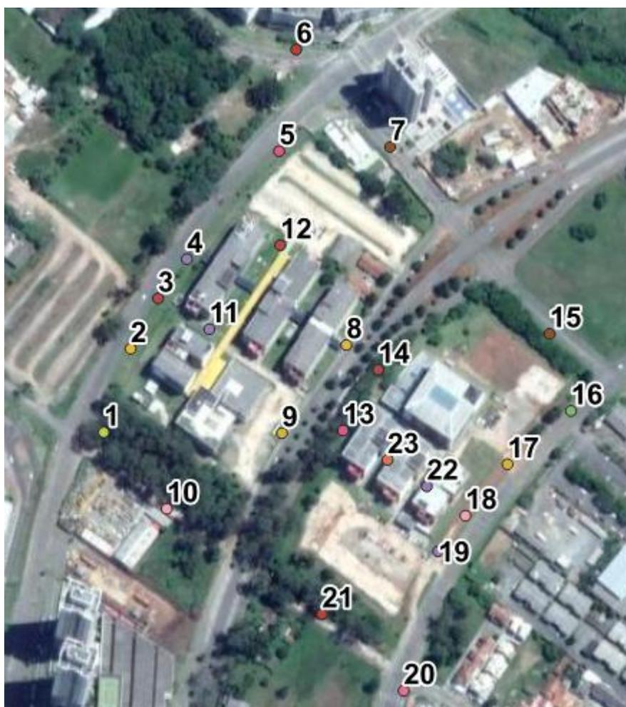
**Figura 16 – Pontos de medição de ruído e contagem de veículos**
