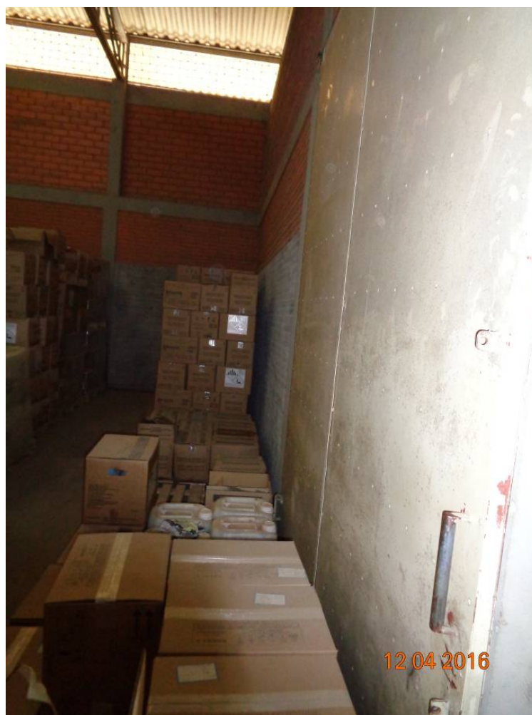
Figura 10 - Produtos com menos de 0,5m de afastamento Fonte: O Autor.
