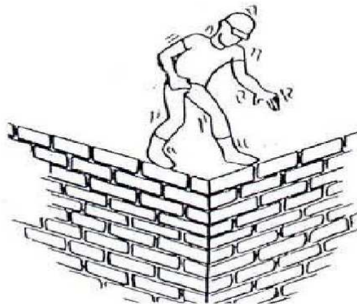
Figura 7- Causa de quedas: método incorreto de trabalho.
