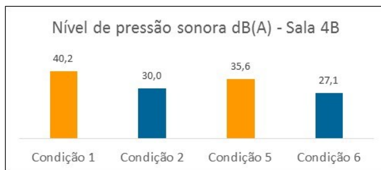
Figura 20 – Níveis de pressão sonora conforme condições de atendimento – sala 4b.
