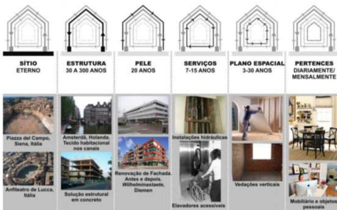
Figura 5: Diagrama de camadas independentes e vida útil correspondente. Montagem.
