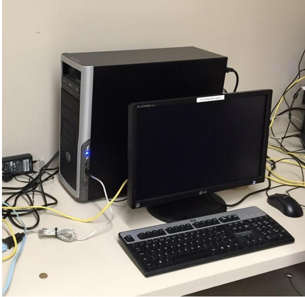
Figura 12 - PC usado como Roteador Quagga
