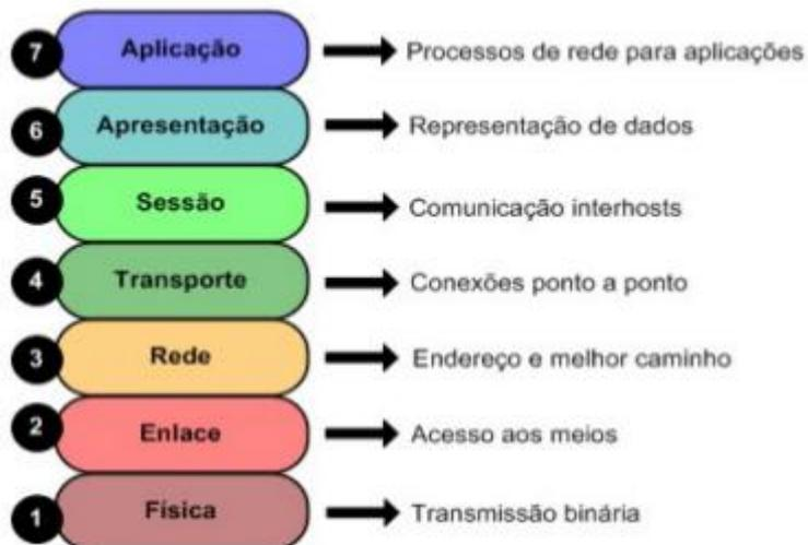
Figura 2- Funções das camadas do modelo OSI
