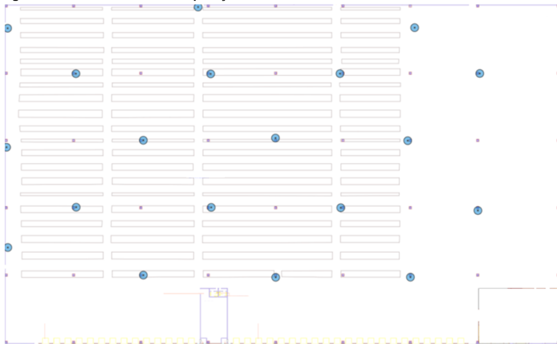
Figura 7 - Planta baixa com disposição dos APs
