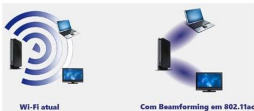
Figura 24 - Comportamento de redes Wi-Fi com e sem beamforming
