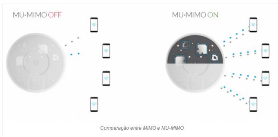
Figura 21 - Comparação entre MIMO e MU-MIMO
