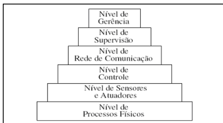
Figura 3 - Automação Industrial em Níveis de Abstração Fonte - SOUZA, L. E.; Arquiteturas de Sistemas de Automação
