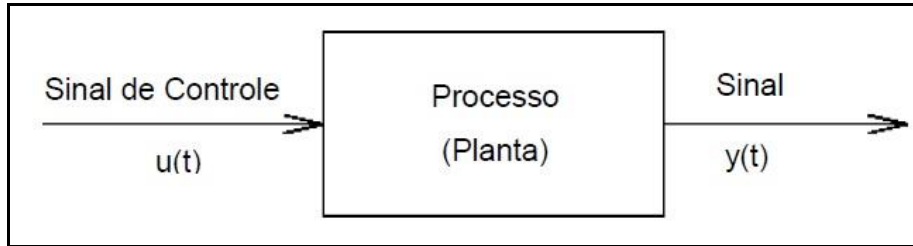
Figura 7 – Diagrama em blocos de um sistema em malha aberta. Fonte: Ogata (1998).
