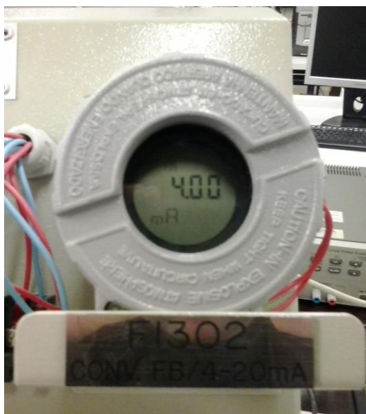
Figura 11 – Conversor FI302 da SMAR. Fonte: Autoria própria.
