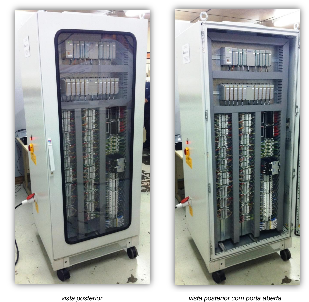
Figura 43 – SCADA Test Bench para simular MCSs Fonte: AkerSolutions (2013)
