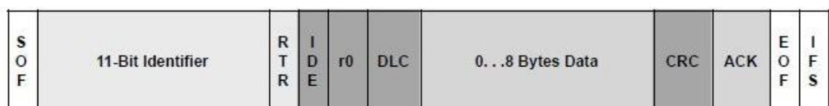
Figura 31 – Formato do quadro CAN padrão Fonte: ISO 11898 (2007)
