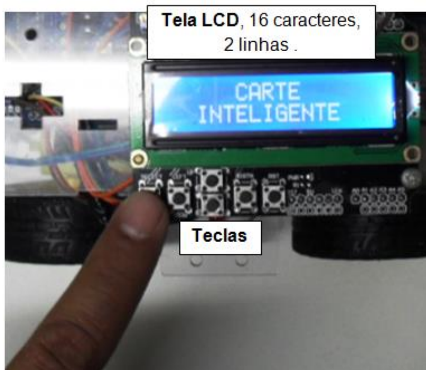
Figura 10 – IHM, Tela LCD com seis teclas. Fonte: Autoria própria (2016).
