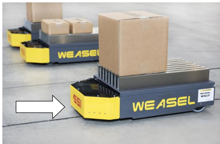
Figura 3 – AGV do tipo carregador. Fonte: Soluções industriais (2016).
