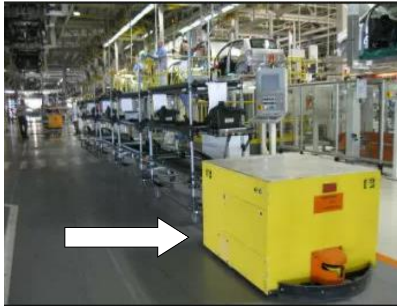
Figura 2 – AGV do tipo rebocador na indústria. Fonte: Sinova (2016).
