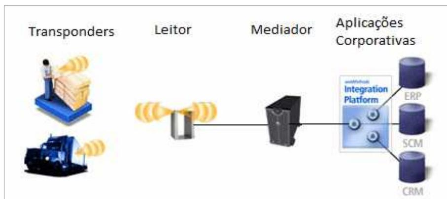
Figura 1. Sistema RFID composto pelo *transponder*, antena e mediador.
