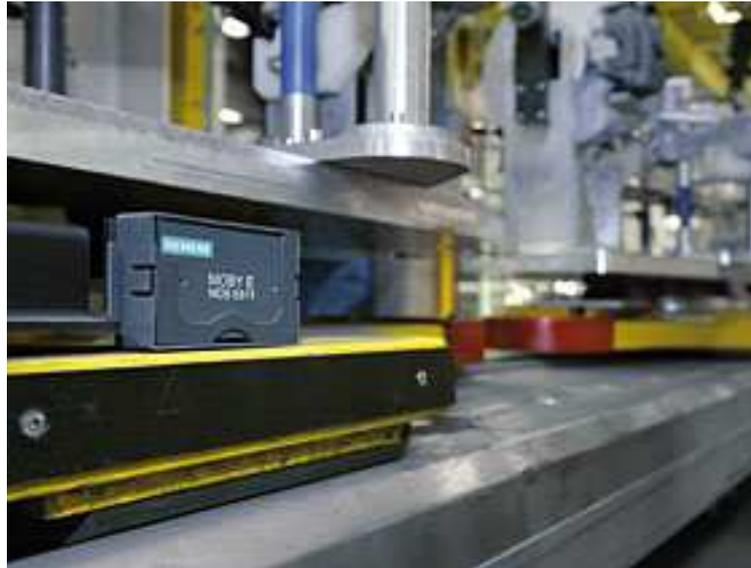
Figura 11. Transponder RFID utilizado na localização dos veículos na fábrica da BMW em Munic, na Alemanha.
