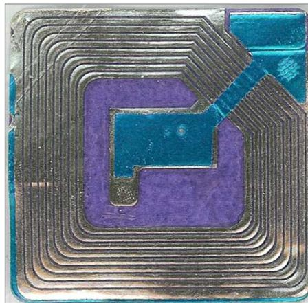
Figura 3. Trilhas de um transponder RFID de 13.56MHz
