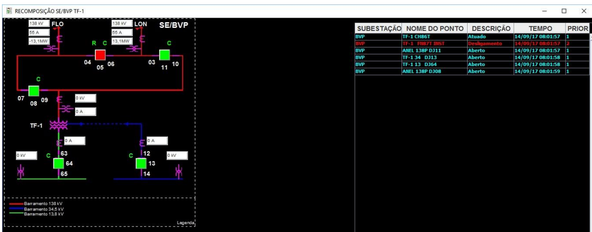
Figura 31 – Resultado para sinalização dos alarmes essenciais ao diagnóstico na tela de recomposição do transformador de subestação Fonte: O autor (2017)
