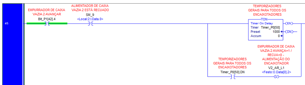
Figura 23- Linha de programa alterada no CLP Fonte: Autoria própria (2015)
