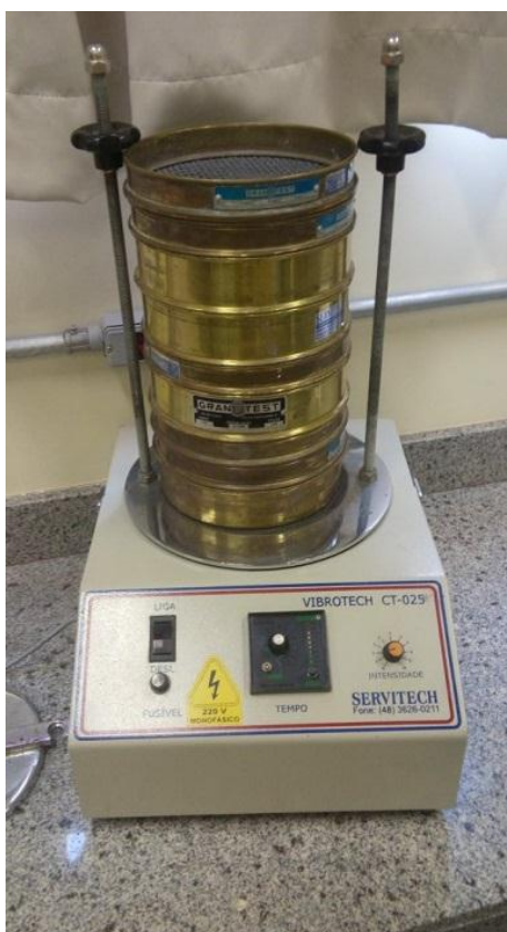
Figura 3: Ensaio de Peneiramento.
