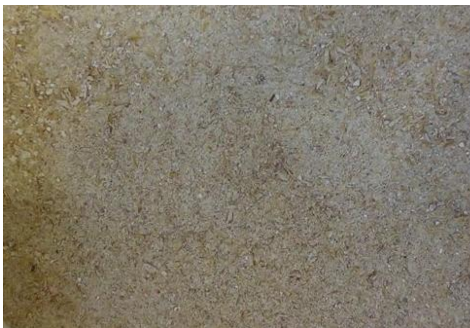
Figura 13: Material triturado por 1 minuto.
