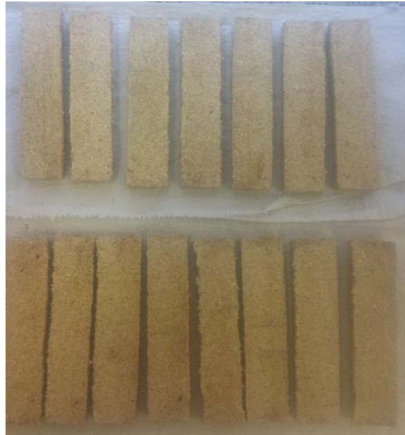
Figura 15: Corpos de Provas com 5g de Cola.
