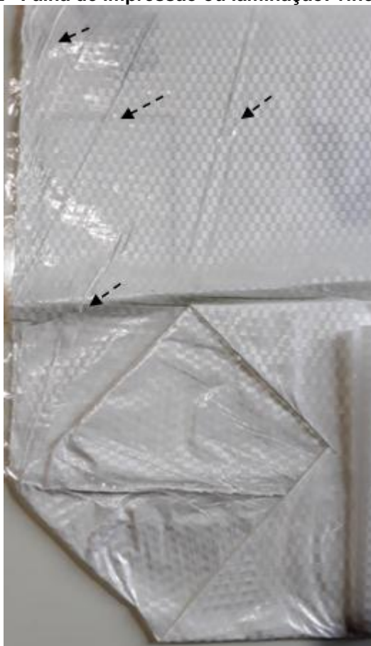
Fotografia 2– Falha de impressão ou laminação: vincos no tecido
