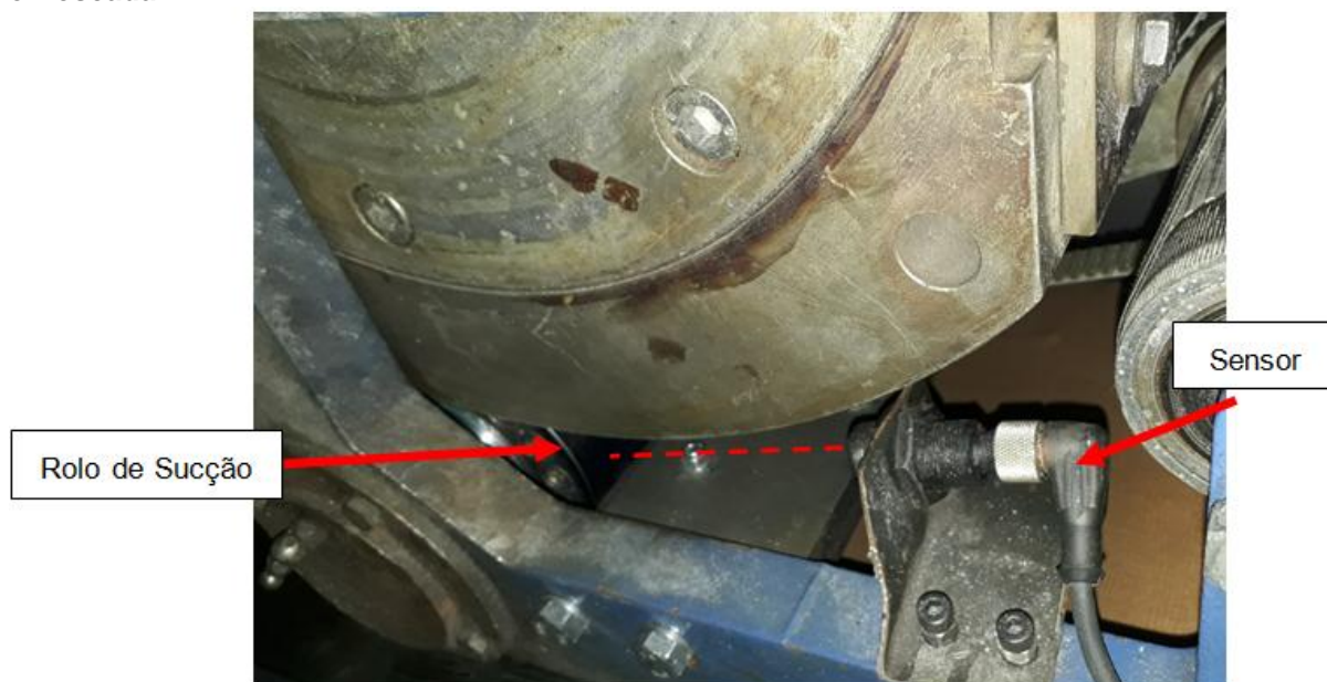
Fotografia 5 - Sensor de supressão de fundo para detectar folha de cobertura ou fundo enroscada
