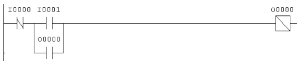
Figura 6: Diagrama de uma partida direta em LADDER
