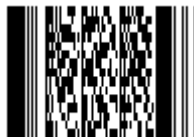
Figura 3 - Código de barras 2D com pilha Fonte: (DENSO, 2010)
