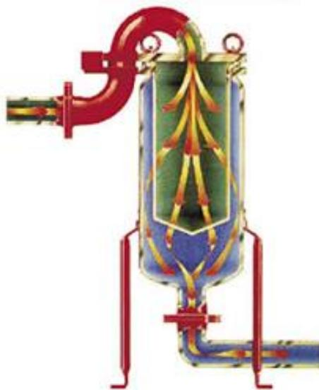
**Figura 04 – Modelo do sistema de funcionamento de um filtro tipo bolsa.**
