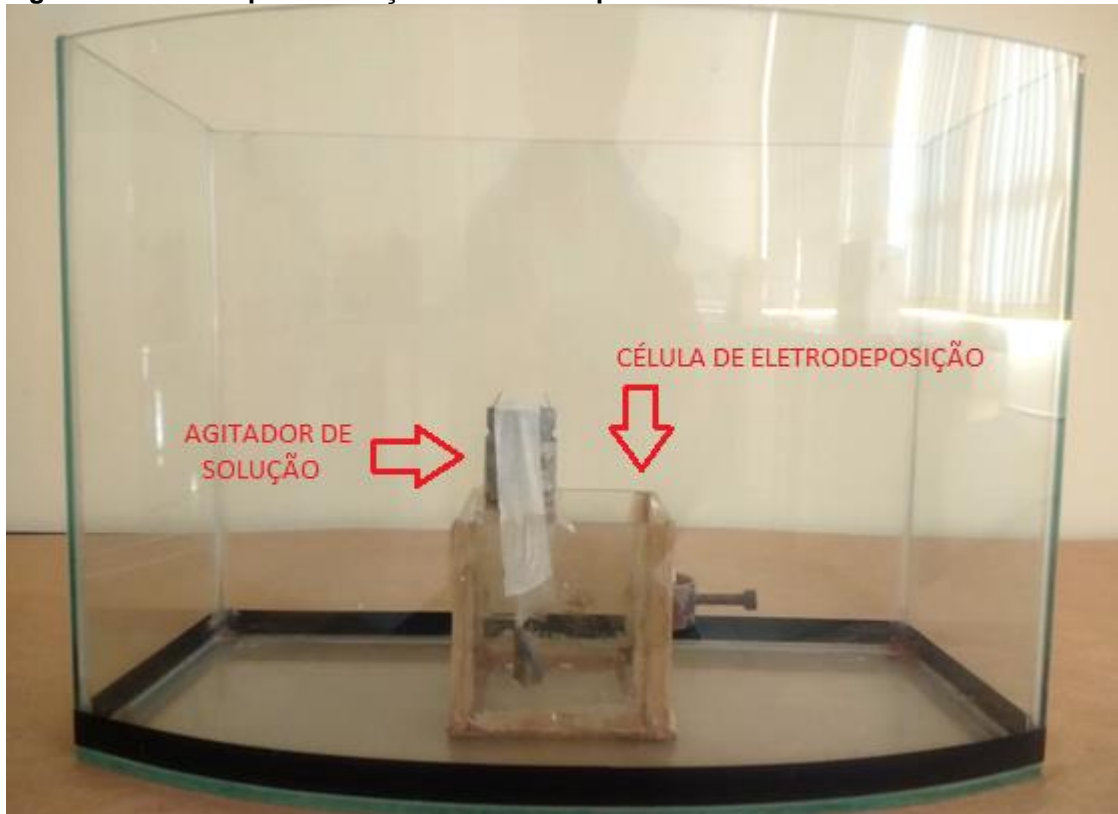
Figura 5 – Sistema para obtenção dos eletrodepósitos.
