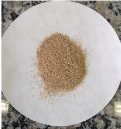
Figura 10: Aparência da fibra de bagaço de malte após peneiramento e seleção da granulometria de 0,250 mm
