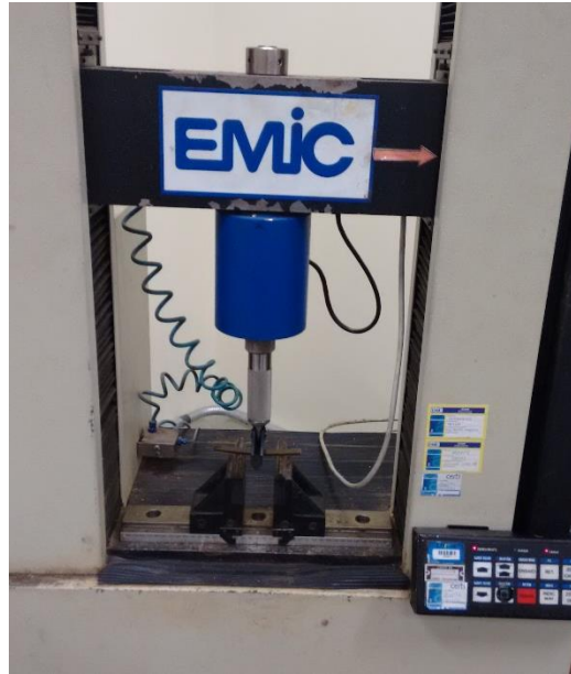
Figura 17: Equipamento utilizado no ensaio Resistência a Flexão
