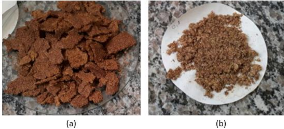
Figura 11: Fibras de Bagaço de Malte mercerizadas (a) 0,25 mol/L NaOH; (b) 0,1 mol/L NaOH
