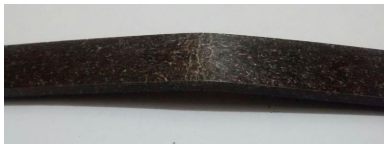
Figura 19: Corpo de prova após ensaio de flexão
