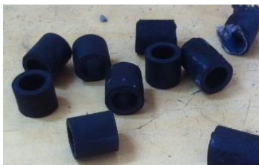
Figura 7- Resíduo de pneu pré-tratado que irão substituir os agregados graúdos
