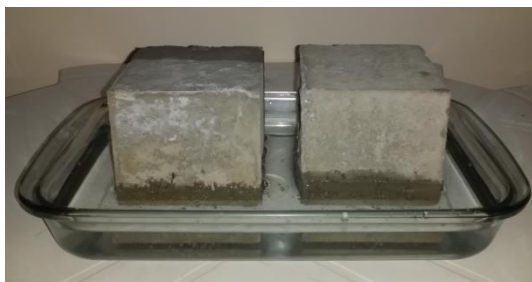
Figura 9 – Corpos de prova sob ação de soluções ácidas
