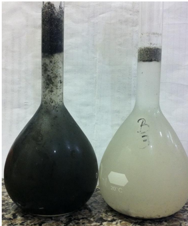
Figura 22 - Representação da remoção de cor do efluente têxtil bruto.
