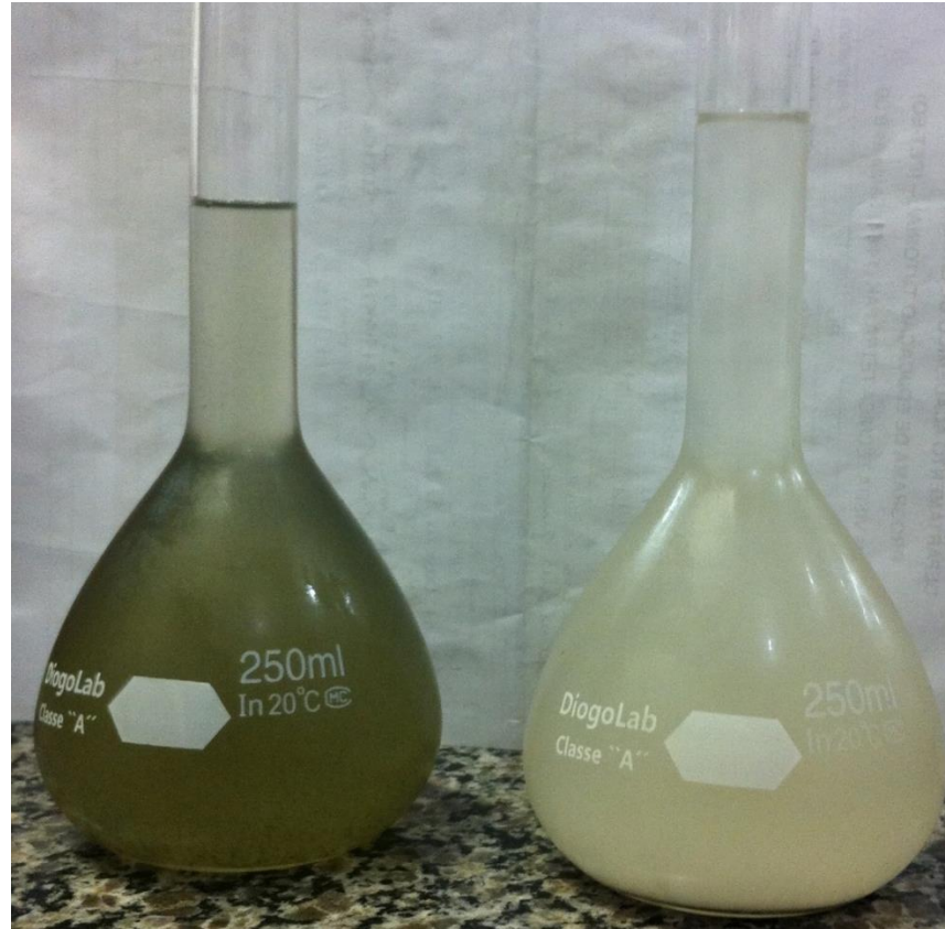
Figura 17 - Representação da remoção de cor do efluente têxtil peneirado no teste fotocatalítico.
