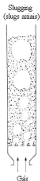
Figura 5 – Slugging ou slugs axiais. Fonte: Kunii e Levenspiel (1991).
