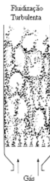
Figura 7 – Leito Fluidizado Turbulento. Fonte: Kunii e Levenspiel (1991).
