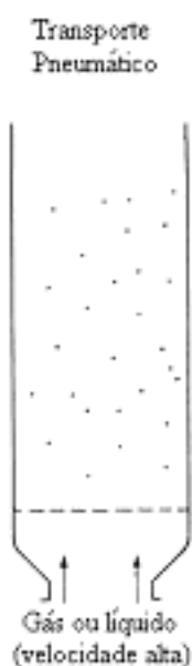
Figura 8 – Transporte Pneumático. Fonte: Kunii e Levenspiel (1991).
