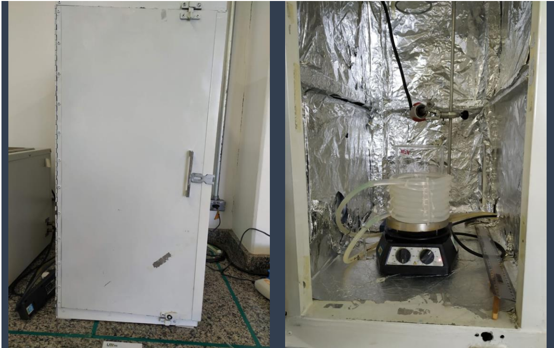
Figura 13 - Fotografias da câmara de fotocatalise utilizada nos testes cinéticos
