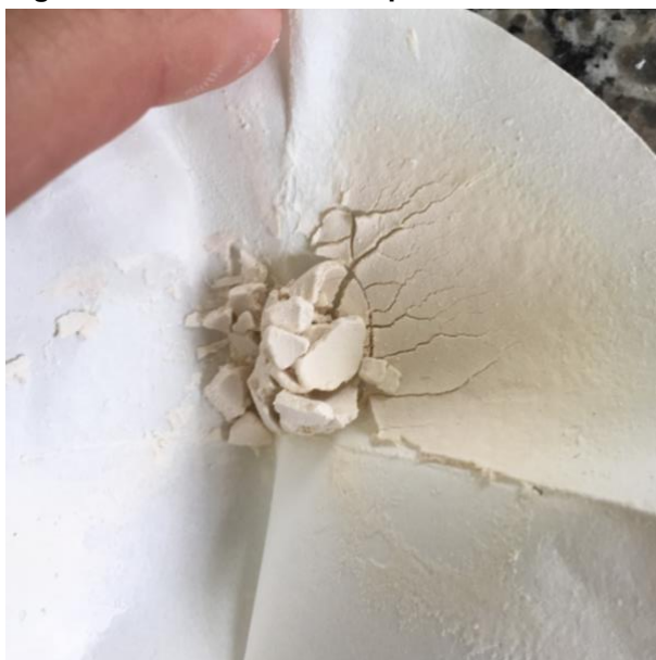
Figura 10 - Catalisador recuperado e lavado com hexano
