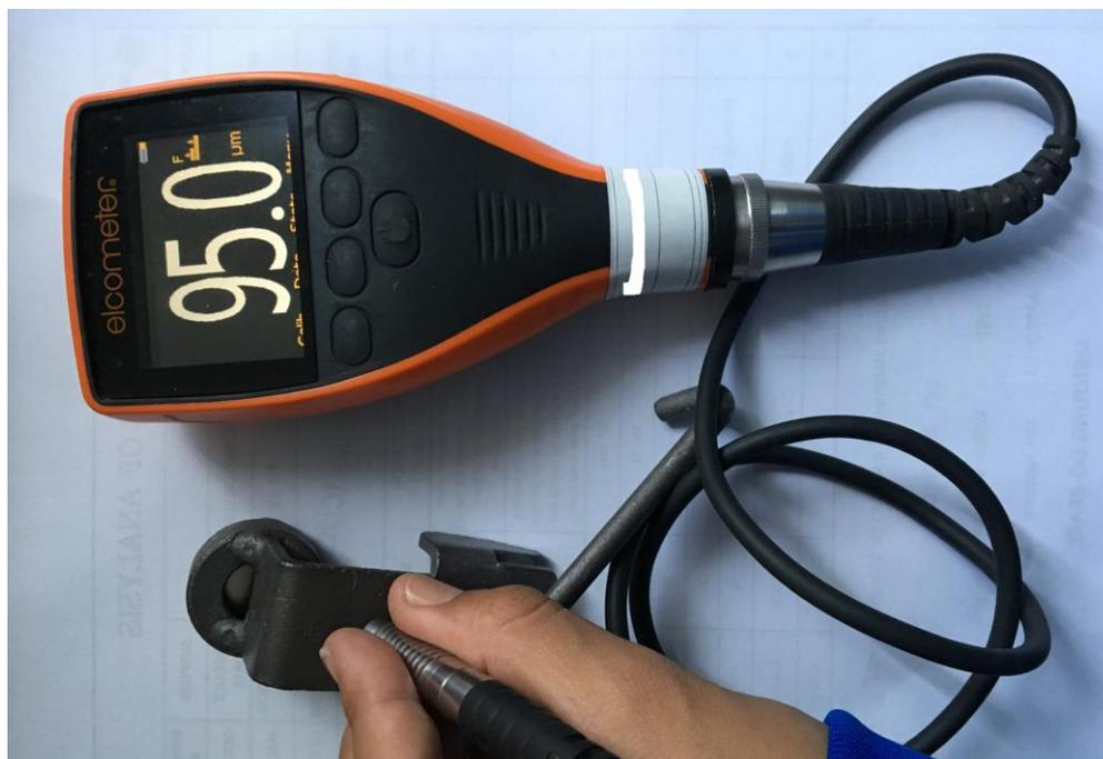
**Figura 11 - Medição espessura de camada na parte externa em dispositivo 1D**
