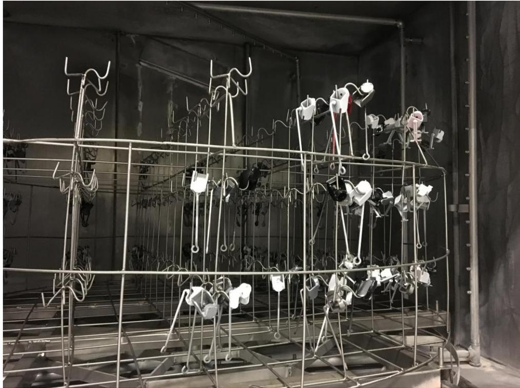
**Figura 8 - Cesto carregado de dispositivos para decapagem**
