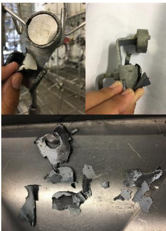
**Figura 14 - Filmes de revestimento de tinta decapados**
