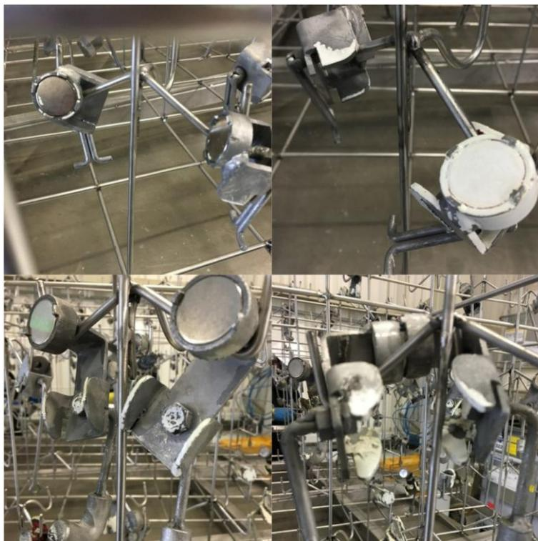
**Figura 12 - Dispositivos com limpeza incompleta**
