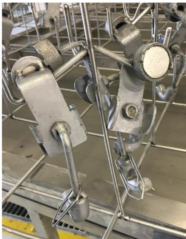
**Figura 9 - Dispositivos de exposição intensificada à solução decapante**
