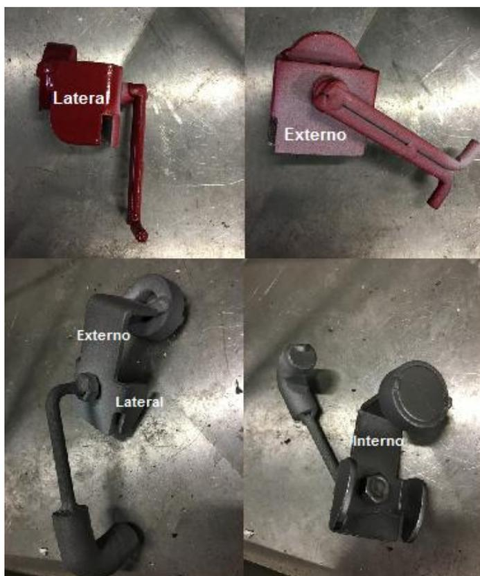
**Figura 10 - Áreas de medição de camada nos dispositivos**
