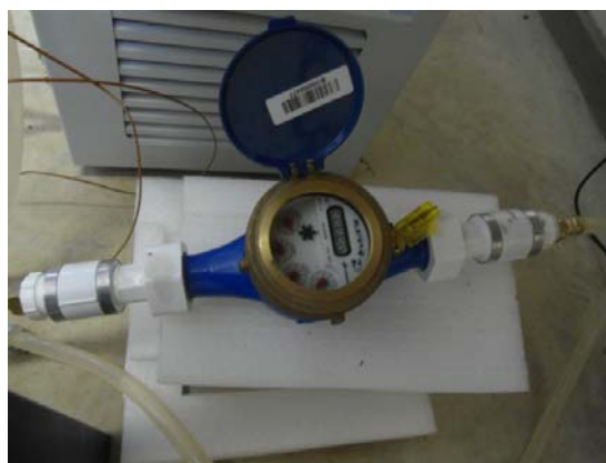
Figura 22 – Hidrômetro SANEPAR. Fonte: Autoria própria
