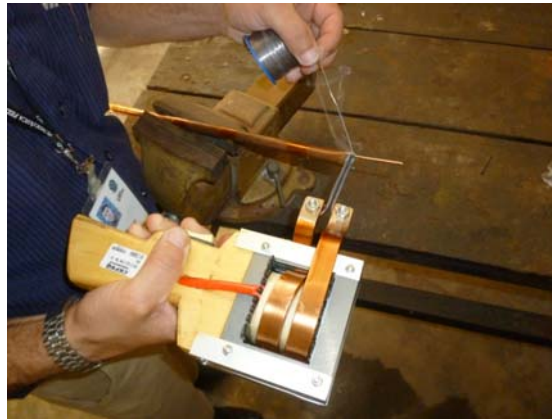
Figura 12 – Solda para selar o termossifão.
