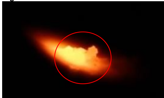
Figura 1 – Crosta de óxido formando-se durante a soldagem
