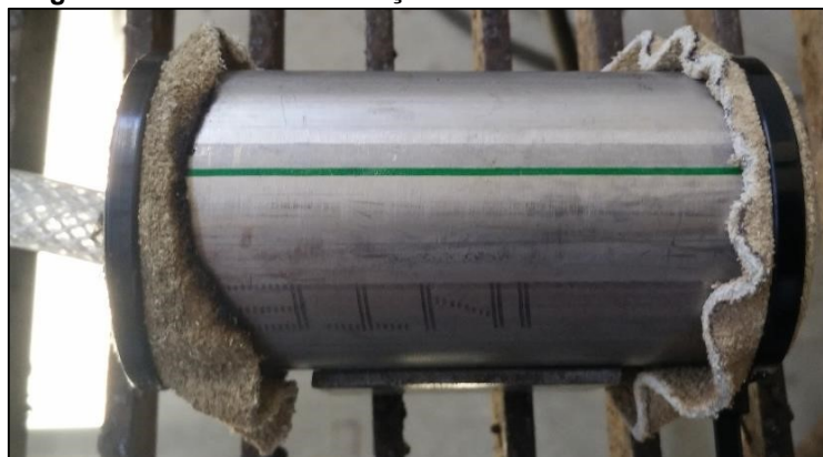
Figura 12 – Método de vedação do tubo
