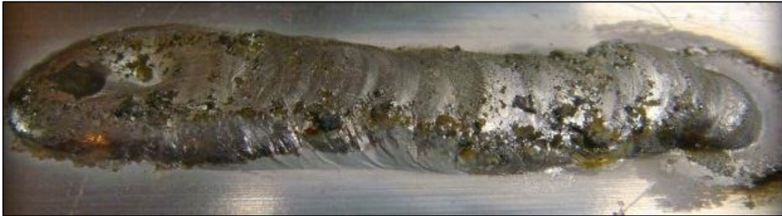
Figura 8 – Cordão de solda contaminado
