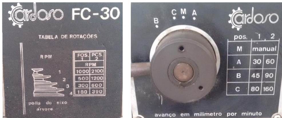
Figura 12 - Velocidades de rotação e avanço disponíveis na fresadora.
