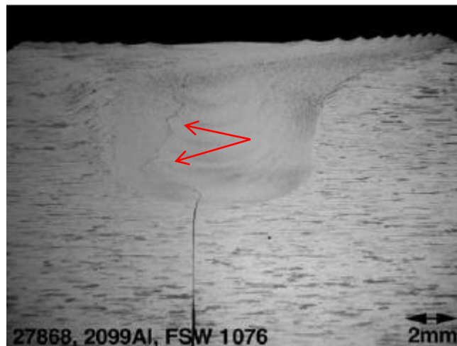
Figura 8 - Falha tipo " kissing bond " em macrografia de uma solda por Friction Stir Welding .
