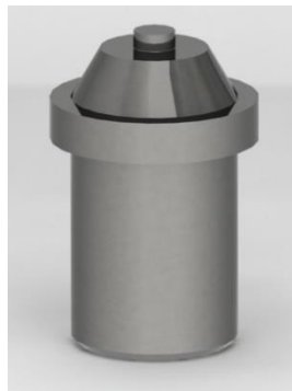
Figura 14 - Ferramenta utilizada nos experimentos de soldagem FSW.
