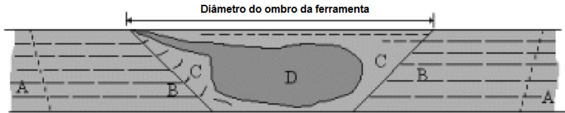
Figura 4 - Seção transversal de uma junta soldada por FSW indicando as regiões de diferentes microestruturas.
