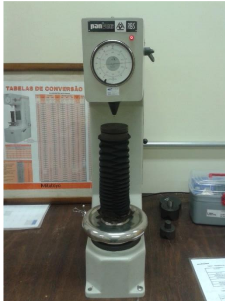
Figura 31 - Equipamento de ensaio de dureza (marca Pantec modelo RBS). Fonte: Autoria própria.
