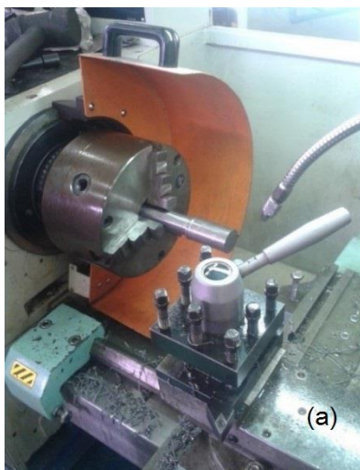
Figura 26 - Usinagem dos corpos de prova. (a) Aço SAE 1045. (b) Aço SAE 4340. Fonte: Autoria própria.
