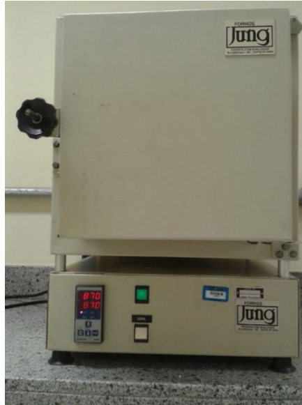
Figura 28 - Forno tipo mufla (processo de normalização). Fonte: Autoria própria.
