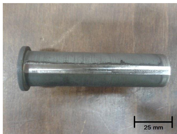
Figura 32 - Corpo de prova do aço SAE 4340 logo após a medição de dureza. Fonte: Autoria própria.
