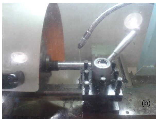
Figura 26 - Usinagem dos corpos de prova. (a) Aço SAE 1045. (b) Aço SAE 4340. Fonte: Autoria própria.
