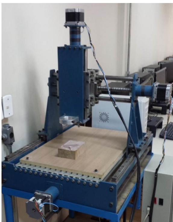
Figura 9 - Fresa CNC construída pelo professor José Alexandre Campos Fonte: Autoria própria
