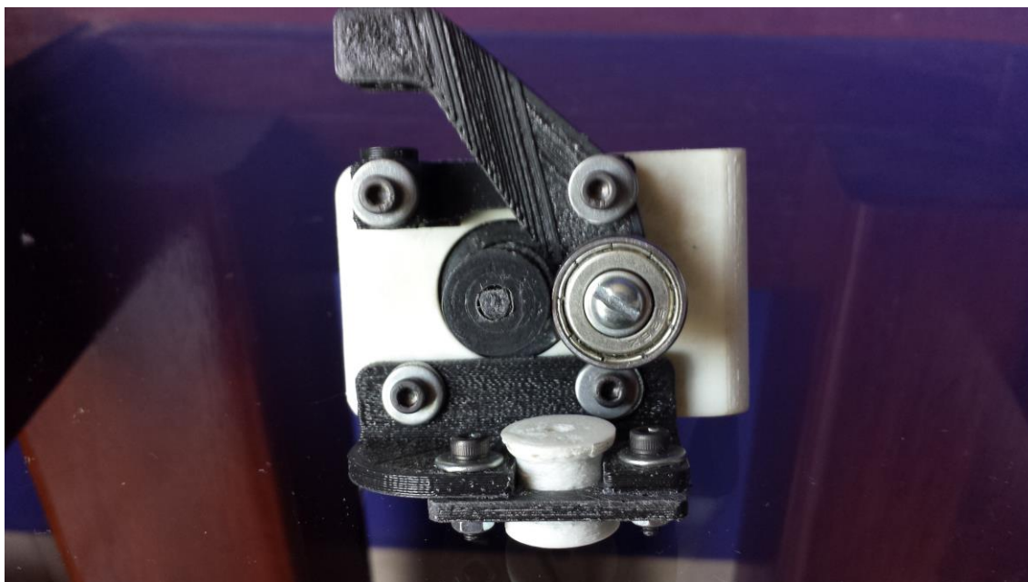
Figura 22 – Cabeçote extrusor impresso por FDM Fonte: Autoria própria
